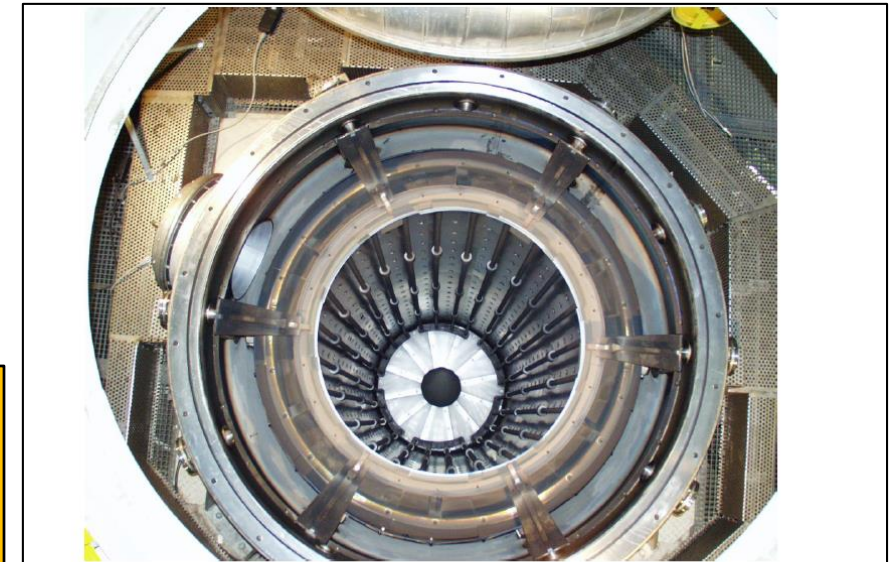
Fig. 17 : Vue depuis le haut du four de 'vacuum firing' du CERN. Les dimensions utiles sont d'environ 6 m par 1 m de diamètre.
