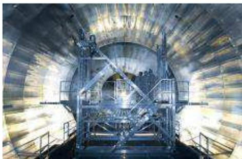
L'expérience KATRIN vise à mesurer la masse du neutrino par le biais de mesure cinématique de haute précision de l'énergie de l'électron issue de la désintégration beta du *Tritium*. Pour cette mesure, il est nécessaire d'avoir :
