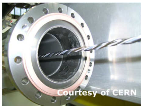
Figure 2 : Chambre à vide avec revêtement NEG et cathode
