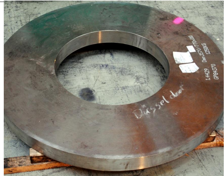
Front flange billet EN 1.4429 (S31653) low activation SS.
