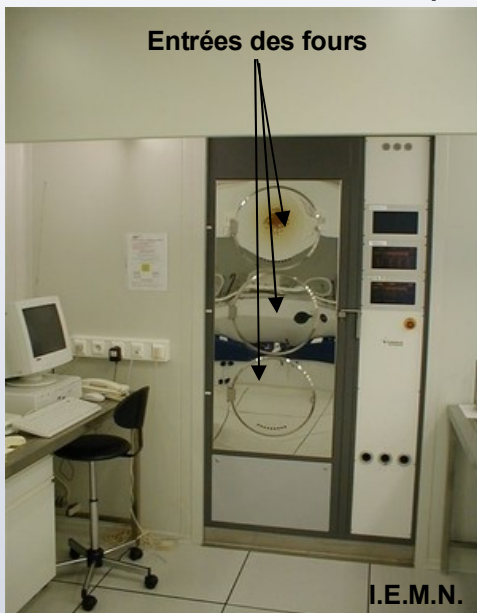
Installation de dépôts par LP-CVD
